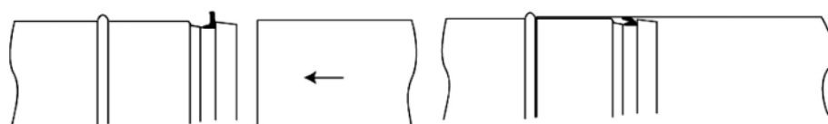
BILD 2. Hopfogning av gummitätade spiralfalsade kanaldelar.
