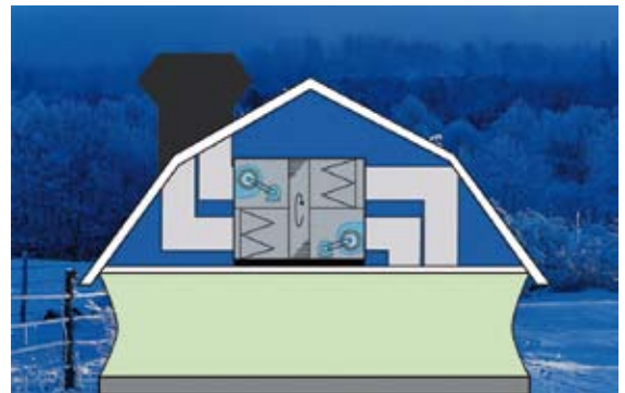
Bild 3: Bei einer Einjustierung bei warmen Temperaturen, z. B. im Sommer, wird der Abluftvolumenstrom auf Grund der veränderten Dichte im Winter zu groß sein. Dies führt zu einem Unterdruck im Gebäude.
